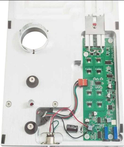
Die komplette Steuerungselektronik ist im Laufwerk selber untergebracht
